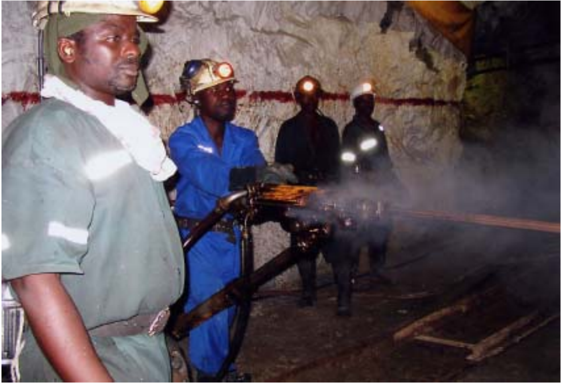
アシャンティ金鉱 ダイナマイト埋め込みのための穴あけ
